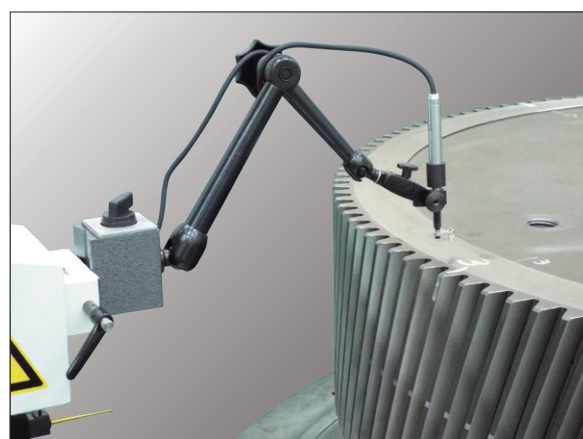
< ZT センサーによる端面振れ画面検出 > < Edge face-Runout detection with ZT sensor >
