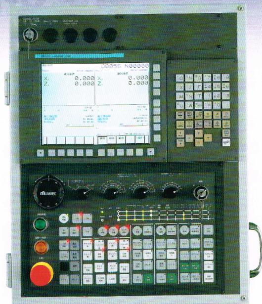
操作盘设置于右侧易操作高度位置，并可 90 度旋回后以轻松姿态进行操作。
