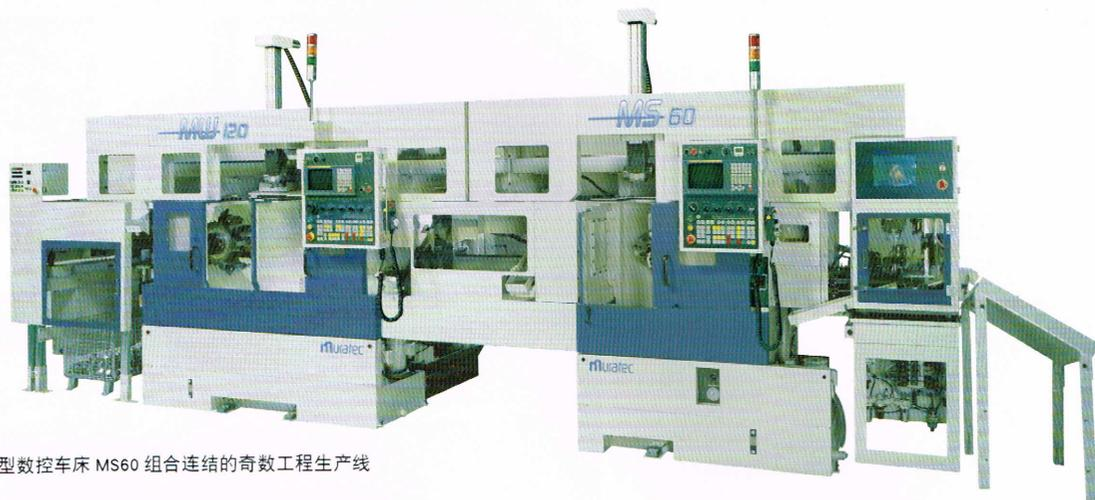
平行双轴型数控车床 MW120 与正面型数控车床 MS60 组合连结的奇数工程生产线
