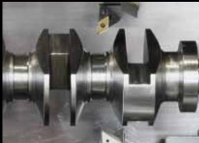
外径加工において、第1、第2タレットの移動を同期化し、高精度のバランスカットを可能にします。
